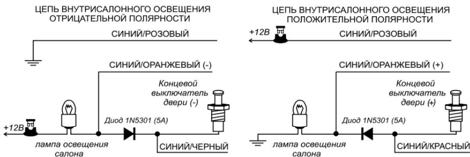
**Внимание!** Обязательно используйте диод для изолирования цепи управления внутрисалонным освещением от цепи триггера двери. В противном случае не сможет правильно работать функция пассивной постановки на охрану и функция автоматической повторной постановки системы в режим охраны.
